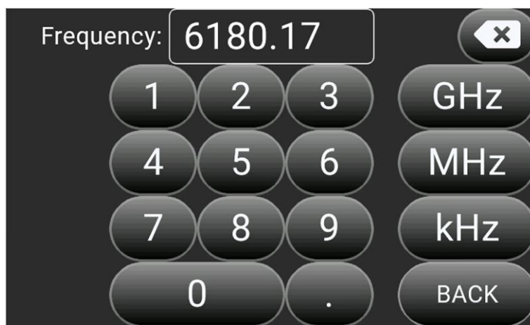
Рисунок 10.1 – Ввод частоты выходного сигнала
